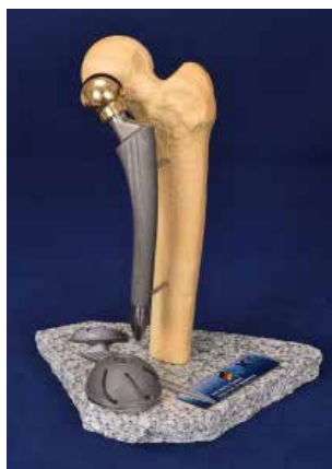
Эндопротездің макеті «ҚазТОҒЗИ» Н. Батпенновтың нұсқасы атты жамбас-ұршық буынына арналған цементсіз бекитін құрылғы.
